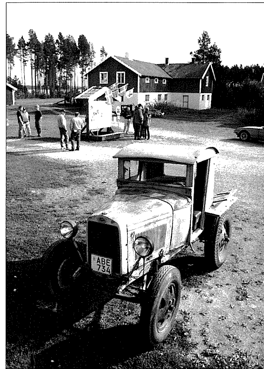
En tidig epa-traktor byggd på en AA-Ford, från slutet av 1920-talet, gladda deltagarna när den rullade in för egen maskin till Hovermo Gårdsmuseum. Foto: Kjell Persson
