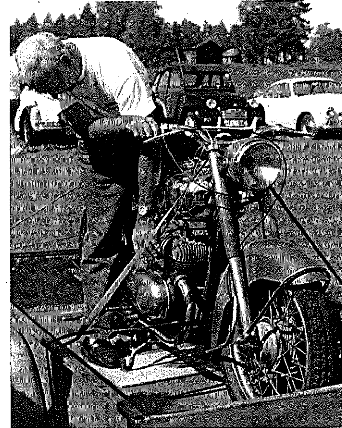
Svalan Radex från 1954. En sällsynt fågel. Motorn är 2-cylindrig och på 250 cc.
