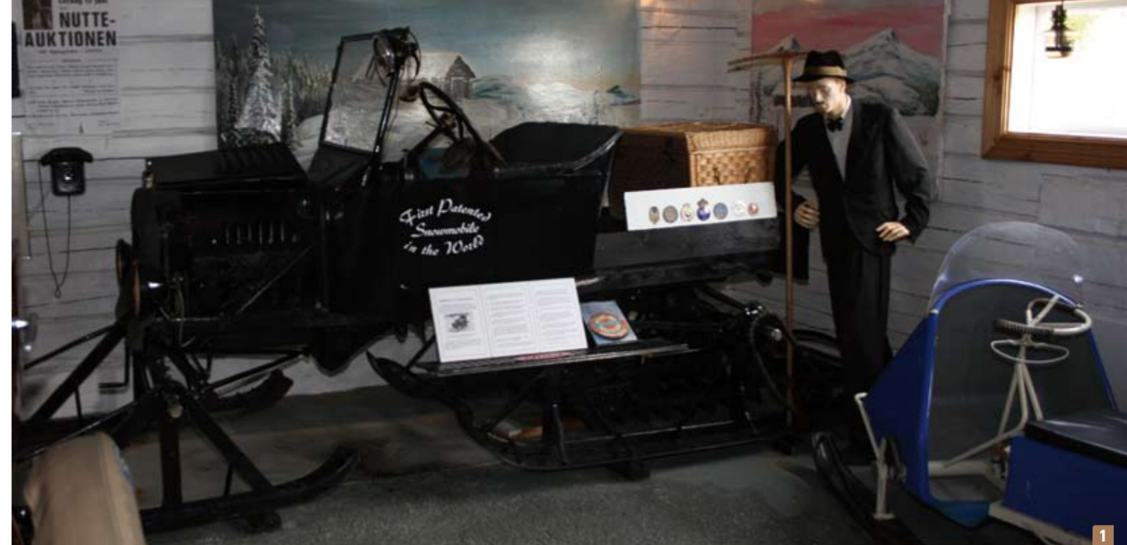
1. Den unika motorsläden byggd av tvillingbröderna Johannes och Olof Löfström. T. h. på bilden syns en Rajd Turist med midjestyrning och ratt och försedd med 16 hkr Sachs motor. Kostade ny 1969 6 150 kr.
